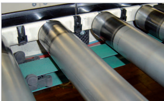
Плоский ремень в составе приводного роликового конвейера
