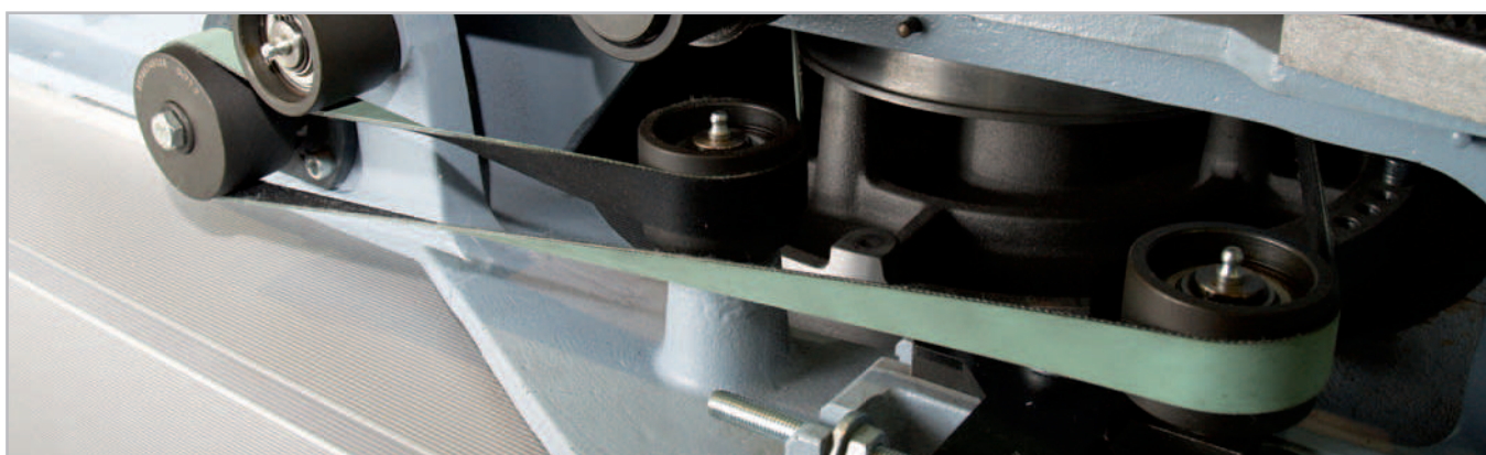
Привод текстильного станка с перекручивающимся плоским ремнем
