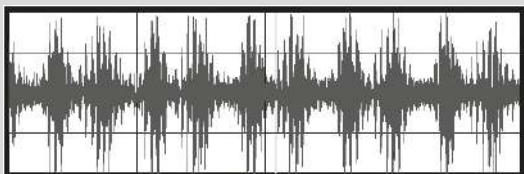
Рис. 2 – Форма звукового сигнала подшипника с царапинами
